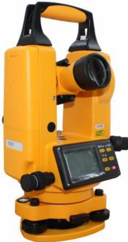
Рисунок 6 – Электронный теодолит Vega TEO 20
