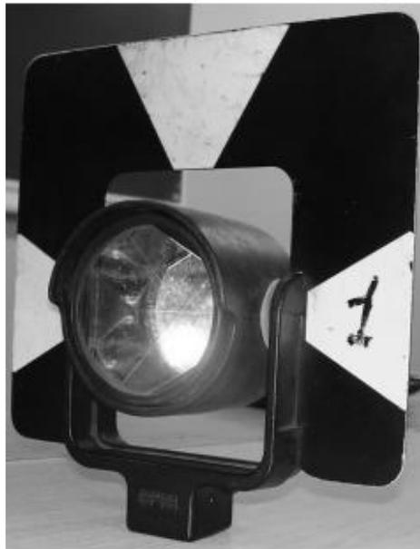
С помощью визирного приспособления производят предварительное наведение на отражатель, который стоит на т. В. После этого наводящим винтом наводят перекрестие сетки нитей на центр отражателя. Это необходимо потому, что в этом случае мы получим максимально мощный отраженный луч. Если мы, наведём, на край отражателя, то часть энергии от тахеометра пройдет мимо отражателя и оставшаяся часть энергии будет меньше. После точного наведения на отражатель начать измерение расстояния.
